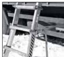
Leiter wird über Gurt am Fahrzeug befestigt. Reflektoren sorgen für gute Sichtbarkeit.
