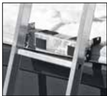
Planenschutzprofil verhindert Beschädigung der Plane.
